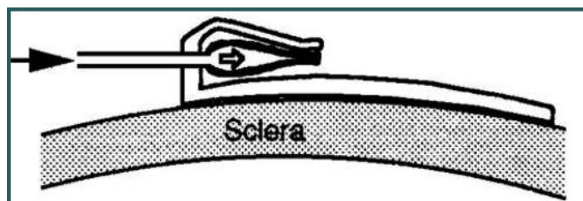
Fig. 9 - Sistema valvolare della protesi di Ahmed: un foglio di silicone opportunamente ripiegato su se stesso consente un passaggio unidirezionale dell'UA alla PIO di 8-10 mmHg.
