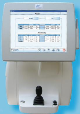
Il sensore Schack-Hartmann analizza le distorsioni di una Wave-Front all'uscita dell'occhio.
