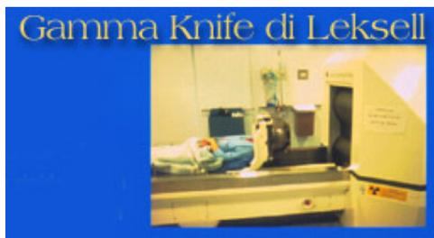
L'unità radiante contiene 201 sorgenti di cobalto-60 collocate in un corpo emisferico centrale. Il raggio emesso da ciascuna sorgente di cobalto viene accuratamente collimato e fatto convergere con precisione in un punto comune, definito isocentro, corrispondente all'intersezione dei raggi nel centro del casco collimatore. La distribuzione geometrica delle sorgenti e il sistema di collimazione assicurano così dosi elevate all'isocentro, di cui
