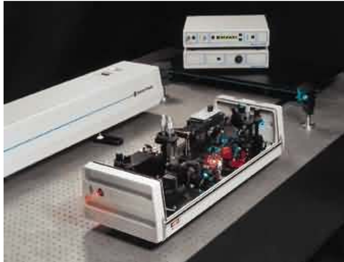
Figura 5 - Laser Tsunami mode-locked al Ti:zaffiro
