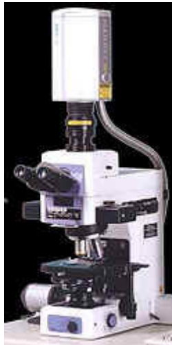
Figura 9 - Microscopio a fluorescenza a multifotone Radiance 2000 della Bio-Rad
