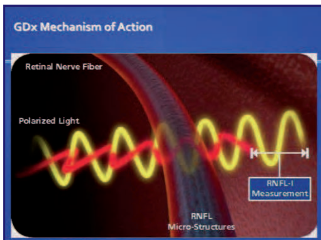
Fig. 5 - Schema della luce polarizzata nel GDx attraverso i microtubuli delle fibre ottiche
